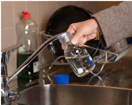
Vid provtagningen får radon inte läcka ut. Därför används speciella provtagningsflaskor.
